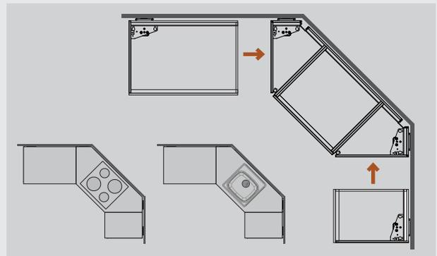
Il modulo angolare è dotato di due motori e può essere utilizzato come un'unità. Può essere integrato con modulo Plus per ottenere la lunghezza desiderata sul lato sinistro e destro. Il piano cottura o il lavello possono essere collocati in angolo.
