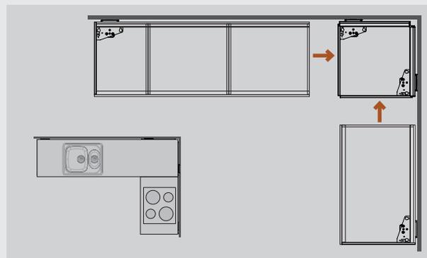
Il modulo angolare è dotato di due motori e può essere utilizzato come un'unità. Può essere integrato con modulo Plus per ottenere la lunghezza desiderata sul lato sinistro e destro. Lavello e piano cottura possono essere inseriti nei moduli Plus.
