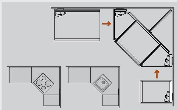
Il modulo angolare è dotato di due motori e può essere utilizzato come un'unità. Può essere integrato con modulo Plus per ottenere la lunghezza desiderata sul lato sinistro e destro. Il piano cottura o il lavello possono essere collocati in angolo.
