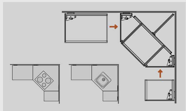
Le module en angle est équipé de deux moteurs et peut être utilisé comme une seule unité. Des suppléments via le Plus module permettent d'obtenir la longueur désirée sur les parties gauche et droite. Une plaque de cuisson ou un évier peuvent être intégrés dans l'angle.
