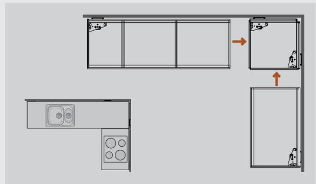
Le module en angle est équipé de deux moteurs et peut être utilisé comme une seule unité. Des suppléments via le Plus module permettent d'obtenir la longueur désirée sur les parties gauche et droite. Une plaque de cuisson ou un évier peuvent être intégrés sur ce modèle.
